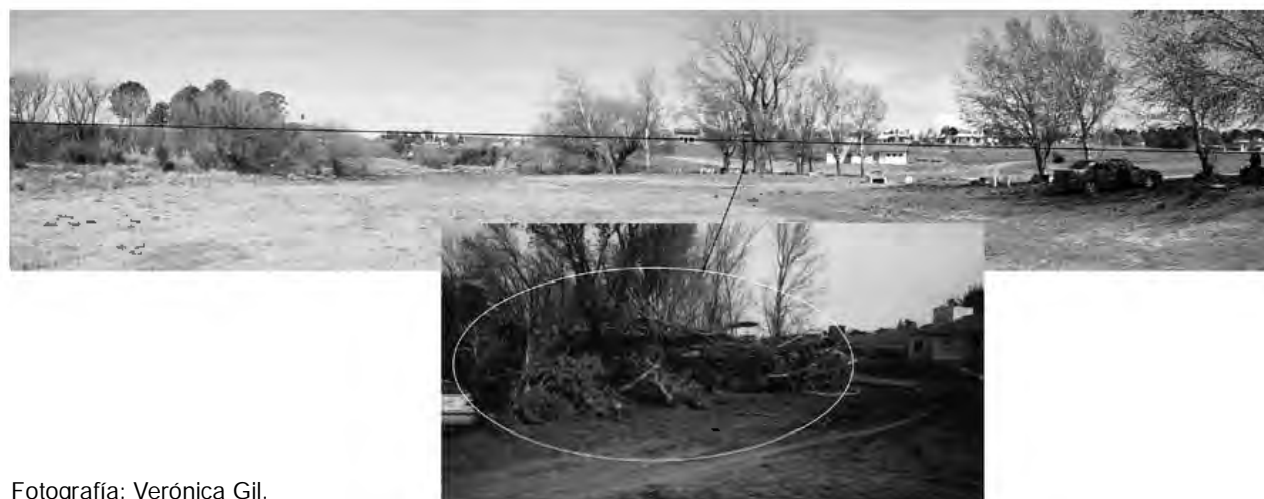
Figura N° 3. Altura del agua en la crecida del 2003 en el sector denominado La Hoya (línea negra continua). En el círculo blanco se observan los troncos y restos de vegetación dejados por la misma crecida a partir de los cuales se estableció la altura aproximada de la línea de agua. El auto y la casa a los costados de la fotografía actúan como escala de referencia.
