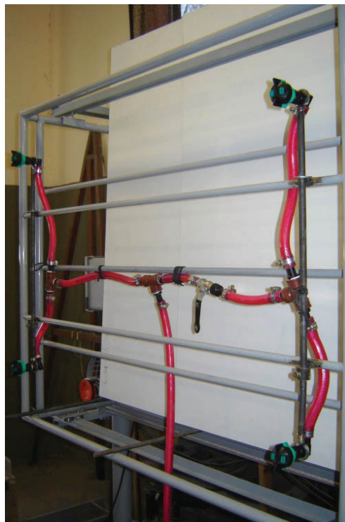
Fig. 1. Dispositivo móvil de aplicación, vista de los barrales verticales y portaboquillas. Fig. 1. Mobile application device, view of the vertical booms and nozzle holders.
