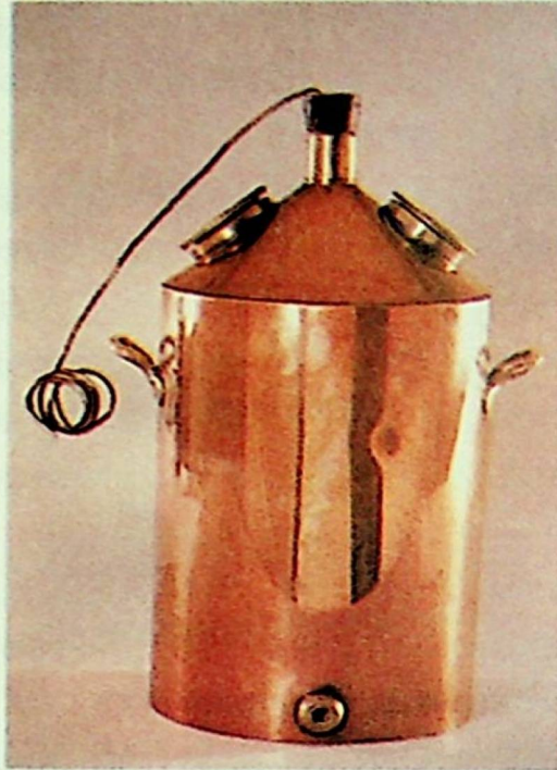
Fig.3. Aparato usado por Pasteur para cultivar levaduras de cervecería (1863).
