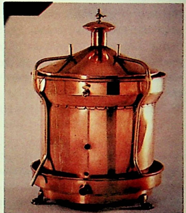
Fig.5. Reactor anaerobio usado por Pasteur en sus estudios sobre la fermentación (1861).
