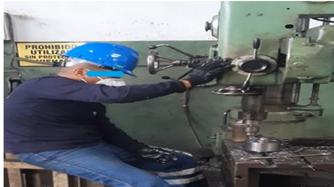
Figura 3. Perforación con taladro estacionario sobre bloque de ocho discos agrupados.
