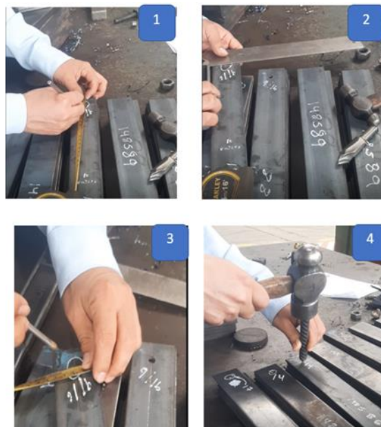
Figura 8. Pasos realizados para la colocación del punto centro en las láminas metálicas.
