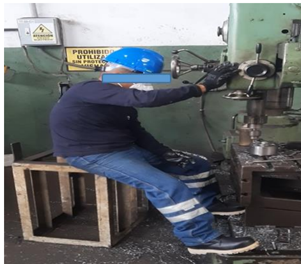
Figura 7. Silla regulable “hechiza” con soporte dorsal elaborada para colaborador.
