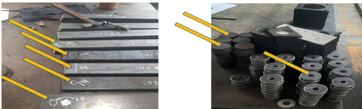
Figura 9. Piezas metálicas con el punto centro trazado por puesto de trabajo 1, para ser proporcionado al puesto de trabajo 2.
