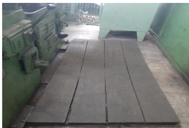
Figura 5. Plataforma de madera (parihuela) con desgaste.
