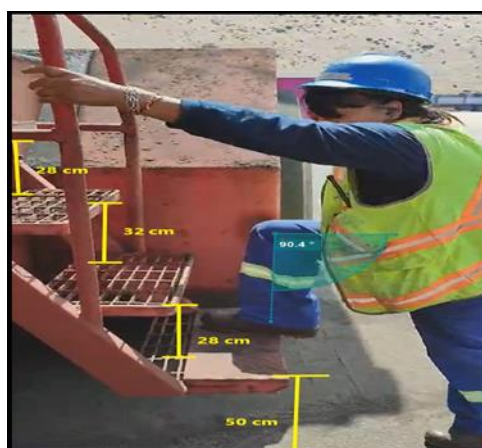
Figura 2. Medidas de las escaleras inferiores en grúa porta contenedor.
