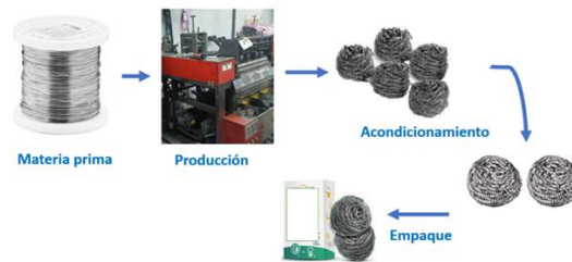
Figura 2. Ejemplo del proceso de fabricación de fibras de acero inoxidable.
