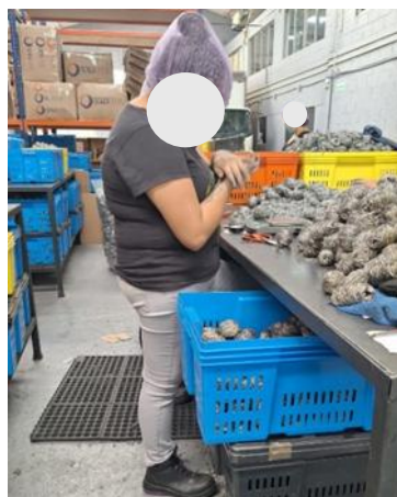
Figura 12. Operaria oprimiendo la fibra semiterminada para obtener la forma final.
