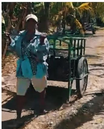
El consenso de las sugerencias de mejoras fue: 1. El mango debe ser ajustable tomando en cuenta el tamaño de la trabajadora. 2. Eliminar el soporte fijo de la carretilla y agregar una rueda pequeña en la parte posterior de ésta y 3. eliminar la lámina que divide los dos niveles. El segundo ensayo con la carretilla mejorada fue de manejo más fácil y con menos esfuerzo físico para empujar o jalar (Figura 8).
